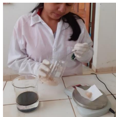
Figura 2. Pesaje de las diferentes dosis de biopolímero antes de la aplicación en el agua con petróleo
