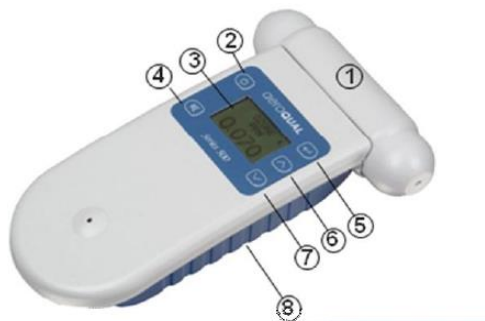
Figura 1. Equipo AEROQUAL con salida 0 a 5 Vdc.
